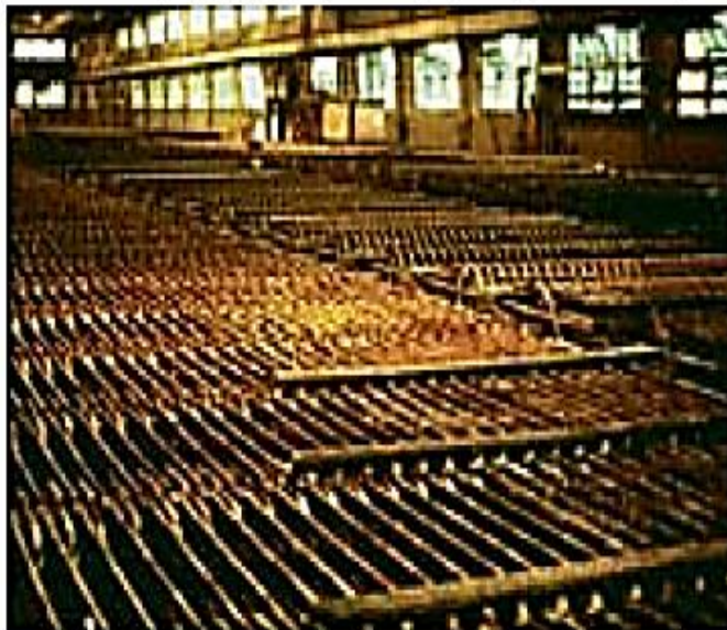
Placas alternadas de cobre puro e impuro sirven como electrodos en las celdas electrolíticas para la refinación del cobre.
